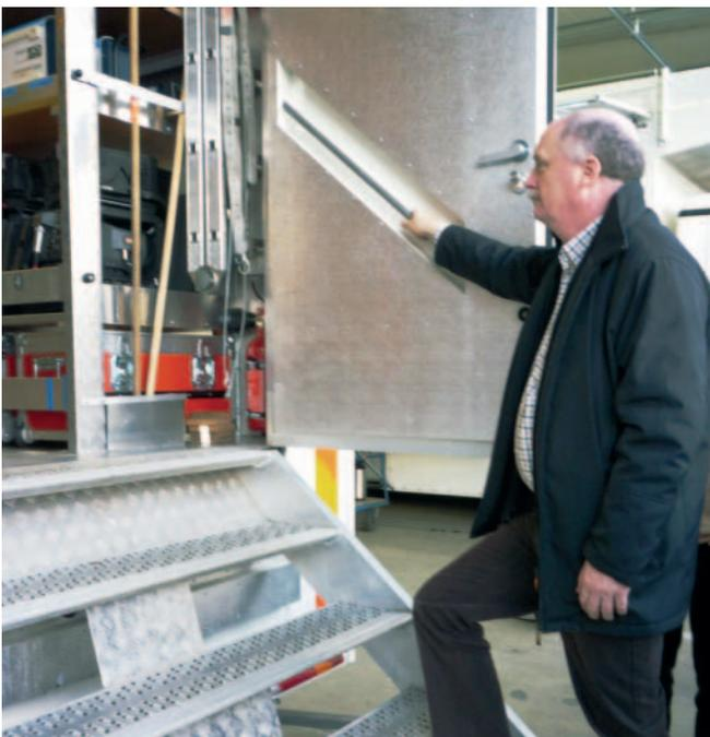
Abbildung 5: Fahrzeugtreppe, Handlauf in Tür integriert
