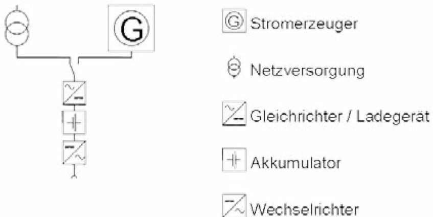
Abb. 4: USV – Anlage mit Stromerzeugerbetrieb
