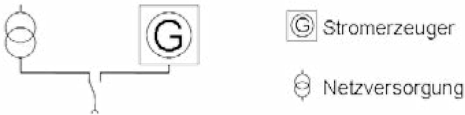
Abb. 3: Umschaltung Netz – Stromerzeuger
