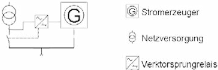
Abb. 5: Umschaltung Netz – Stromerzeuger mittels Vektorsprungrelais
