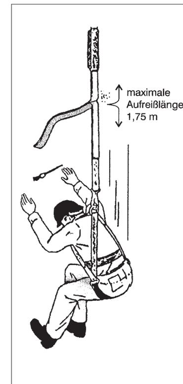
Abbildung 29: Aufreißen eines Bandfalldämpfers
