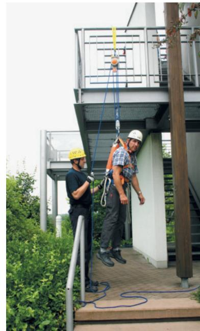
Abbildung 49: Hängeversuch mit Rettungshubgerät – die Versuchsperson wird mit dem Gerät angehoben und kann jederzeit durch die zweite Person abgelassen werden.
