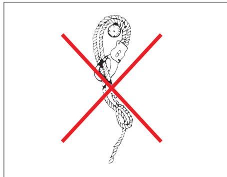
Abbildung 13: Falsches Anschlagen eines Seils mit Falldämpfer
