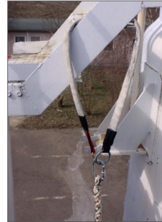
Abbildung 9: Schlinge mit Kantenschutz-Überzug (sogenannte Scharfkantenschlinge)
