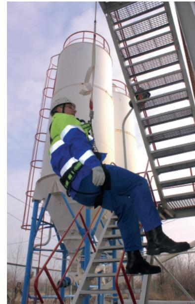
Abbildung 40: Hängen im Auffanggurt (vordere Auffangöse)
