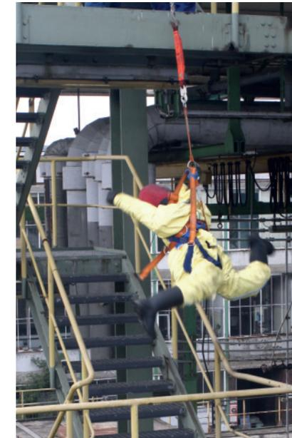
Abbildung 41: Sturzversuch mit einem Dummy
