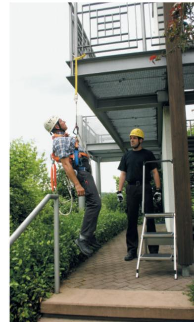
Abbildung 50: Hängeversuch – die Versuchsperson hängt an einem Verbindungsstück. Zum Ein- und Aushängen wird eine Leiter benutzt.
