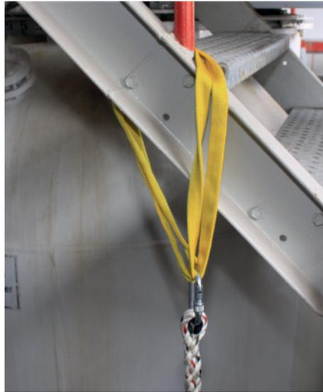
Abbildung 12: Anschlagmöglichkeit mittels Bandschlinge an einer Stahlkonstruktion
