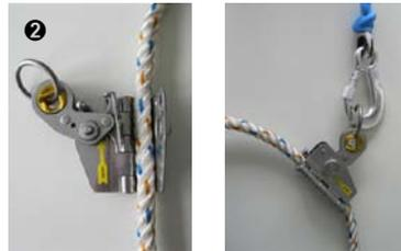
Abb. 23 Einsatz des Rettungsgerätes und einer Seilklemme
