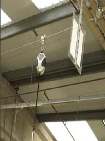
*Hinweis: Die Funktion des Höhensicherungsgerätes kann durch das Nachgeben der Seilführung der Anschlagrichtung beim Auffangvorgang beeinträchtigt werden. Deshalb ist vor der Benutzung eines Höhensicherungsgerätes an einer Anschlagrichtung der Klasse C sicherzustellen, dass das Höhensicherungsgerät für diese Verwendung geeignet ist. Angaben hierzu sind der Gebrauchsanleitung des Höhensicherungsgerätes zu entnehmen.*
