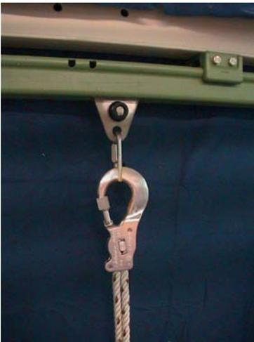
Abb. 17 Anschlagrichtung mit horizontaler Führungsschiene und beweglichem Anschlagpunkt
